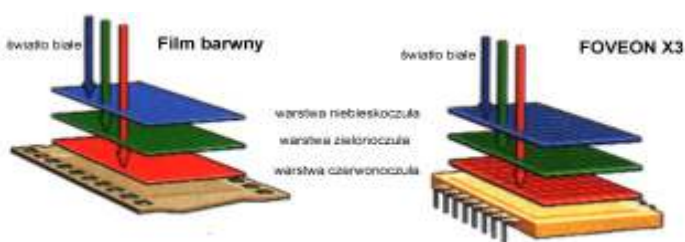
Rys. 11. Przekrój warstwowo matrycy X3 oraz klasycznego materiału fotograficznego barwnego [18]
