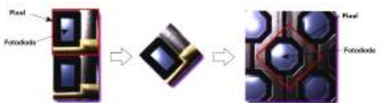
Fot.7. Porównanie kształtu fotoelementów matrycy CCD i Super CCD [7, s. 9]
